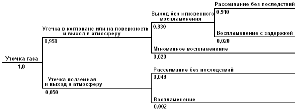
Рисунок 1 – Дерево событий при аварии на межпоселковом полиэтиленовом газопроводе
