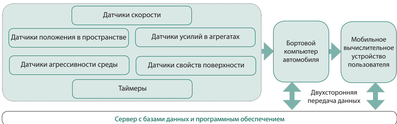
Рисунок 6 – Схема передачи данных в интерактивной системе управления надежностью и ресурсом автомобиля
