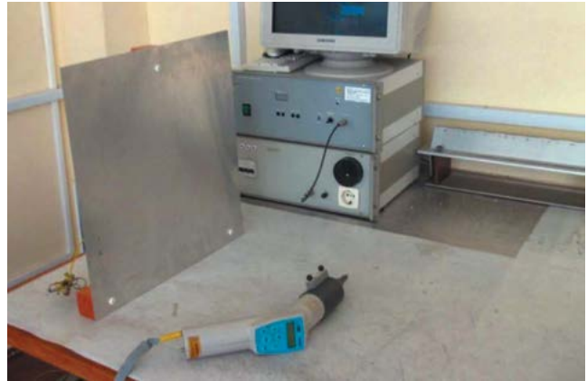
Рисунок 1 – Внешний вид установки для проведения испытаний МТ на устойчивость к воздействию разрядов статического электричества
