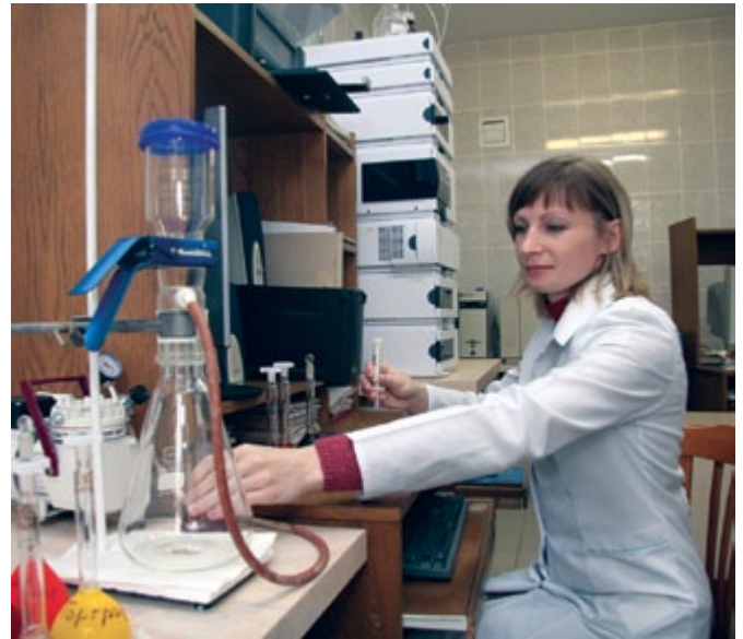
РУП «Калинковичский ЦСМС». Определение синтетических красителей, консервантов, подсластителей, бензапиренов, нитрозаминов на жидкостном хроматографе.
