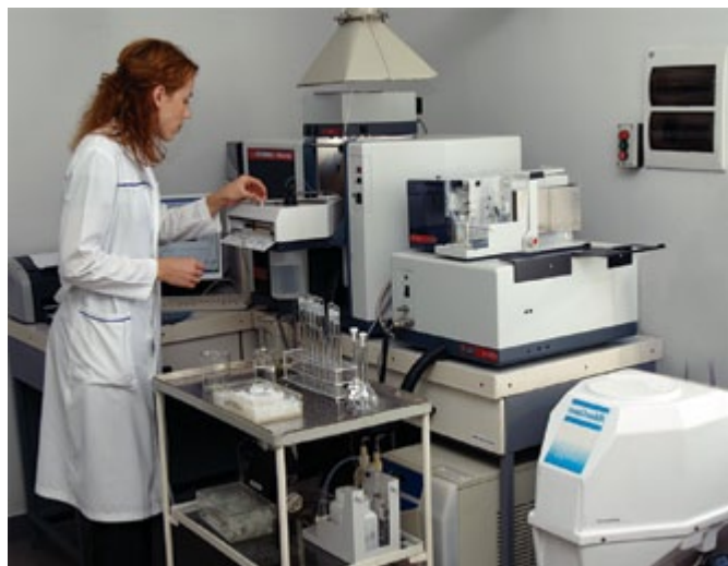
РУП «Брестский ЦСМС». Определение солей тяжелых металлов атомно-абсорбционным спектрометром серии Spectr AA 220 FS.
